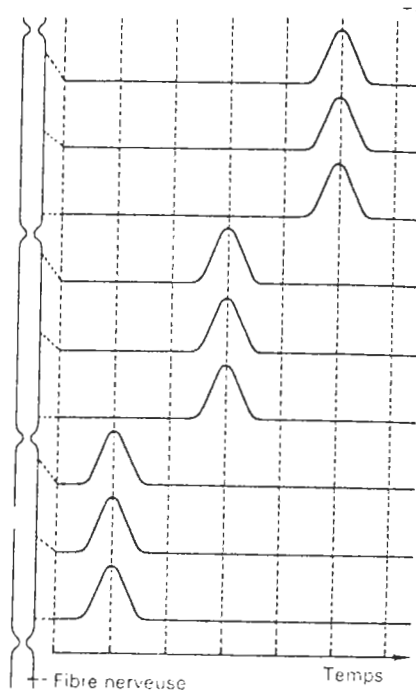
Mise en évidence de la conduction saltatoire par enregistrement des courants d'action en divers endroits
